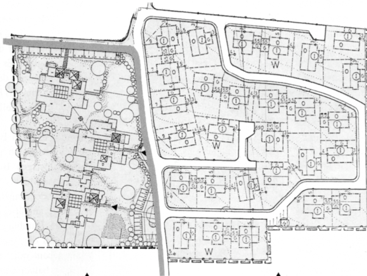
▲ Verkehrsweg verdichtete Gruppenbauweise Atriumhäuser Thürnau - 24 Einheiten
