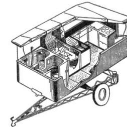
501. Der mechanische Kern. R. Buckminster Fuller, Badezimmer-, Küchen-, Heizungs- und Beleuchtungseinheit. 1945. Transportfertig. Buckminster Fuller erkannte früh, daß das Bad mit den anderen mechanischen Einrichtungen des Hauses zusammengefaßt werden mußte. (Bruce und Sandbank, A History of Prefabrication, New York, 1944)
