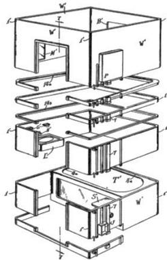
499a. Vorgefertigtes Badezimmer, zerlegt in horizontale Teile. 1934. Die Zelle ist in horizontale Schnitte geteilt, die zusammenschraubt werden. Die Rohrleitungen sind in der Wand untergebracht. (U.S. Patent 2087121, 13. Juli 1937; 1934 eingereicht)
