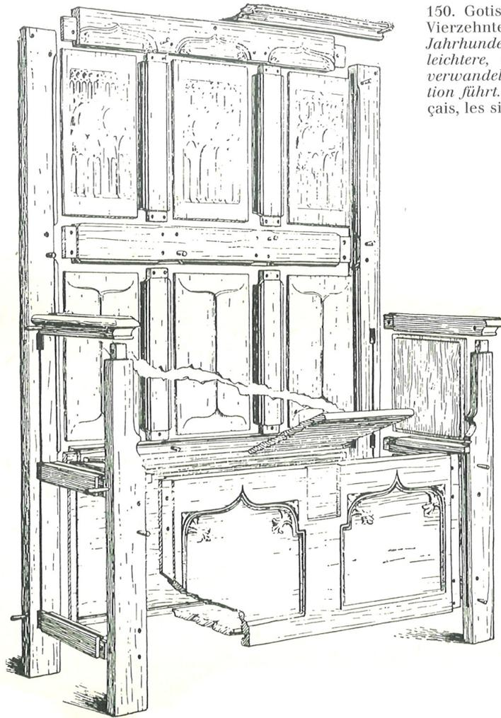
150. Gotische Brettkonstruktion, Lisieux. Vierzehntes Jahrhundert. *Im vierzehnten Jahrhundert werden die schweren Stützen in leichtere, mit Nuten versehene Eckpfosten verwandelt, was später zur Skelettkonstruktion führt.* (H. L. Magne, *Le Mobilier français, les sièges*)
