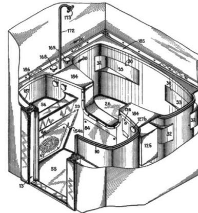
500. Vorgefertigtes Badezimmer in zwei Teilen. R. Buckminster Fuller. 1938. Alle Einzelteile werden gleichzeitig mit der Metallumhüllung gepreßt. Jeder (Quadratmeter) ist sorgfältig geplant worden. (U.S. Patent 2220482, 5. November 1940; 1938 eingereicht)
