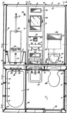
497. Vorgefertigtes Badezimmer, vertikale Wandelemente. 1931. Seit den frühen dreißiger Jahren wurden Patente für das – um Installationskosten zu senken – vorgefertigte Badezimmer erteilt. Hier ist das Badezimmer in Wandelemente geteilt. (U.S. Patent 1978842, 30. Oktober 1934; 1931 eingereicht)
