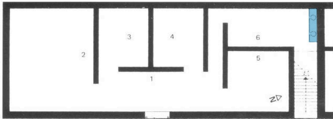
Ostia, Insula III 13,2. Grundriß eines ebenerdigen Apartments des sog. »cassette-tipo«. An den Eingangsbereich (1: Medianum) schließen zwei Repräsentationsräume (2,5) und zwei kleinere Räume (3,4: Cubicula ?) an. Über einen Korridor ist die Küche (6) mit Latrine und einer Abstellkammer unter dem Treppenlauf zu erreichen
