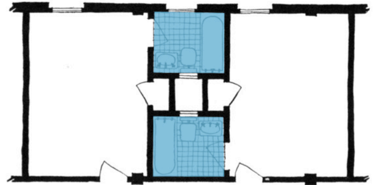
494. Statler Hotel, Buffalo. 1908. Zwei Zimmer, jedes mit Bad und Wandschrank, bilden eine Einheit mit gemeinsamem Lüftungs- und Rohrleitungsschacht. Zu einem frühen Zeitpunkt ist das Kompaktbadezimmer schon voll entwickelt. (Hotels Statler Co., New York)
