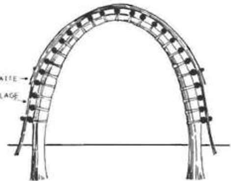
KONSTRUKTION EINER SREFE (WOHNSREFE IN EL HATT BEI BASRA)
